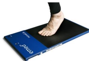
تصویر ۱. نحوه قرارگیری پا در وسط پلت‌فرم و نمایش فشار کف پا از طریق نرم‌افزار
