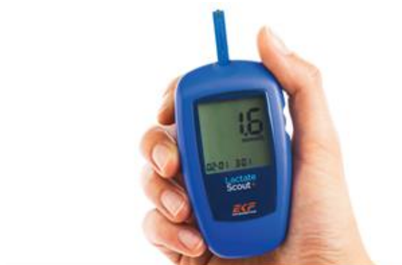
شکل ۱. لاکتات اسکات، دستگاه سنجش لاکتات
