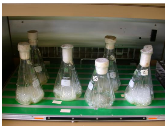
شکل ۴. تولید رامنولیپید درون ارلن‌های ۱۰۰۰ میلی‌لیتری در یک شیکرانکوباتور (۳۷°C و ۱۲۰ rpm) در حین تولید رامنولیپید کف تولید می‌شود.
