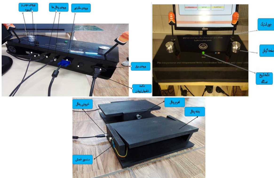
شکل ۵. بخش های سخت افزاری دستگاه هماهنگی حرکتی
