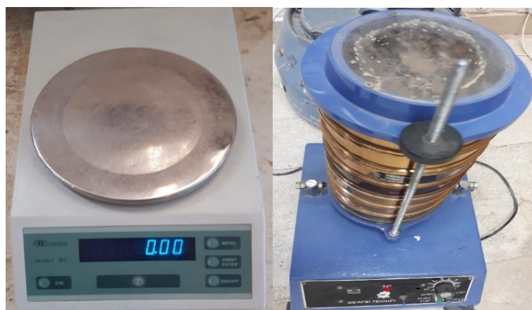
شکل (۳). دستگاه شیکر و ترازوی مورد استفاده جهت آنالیزها
