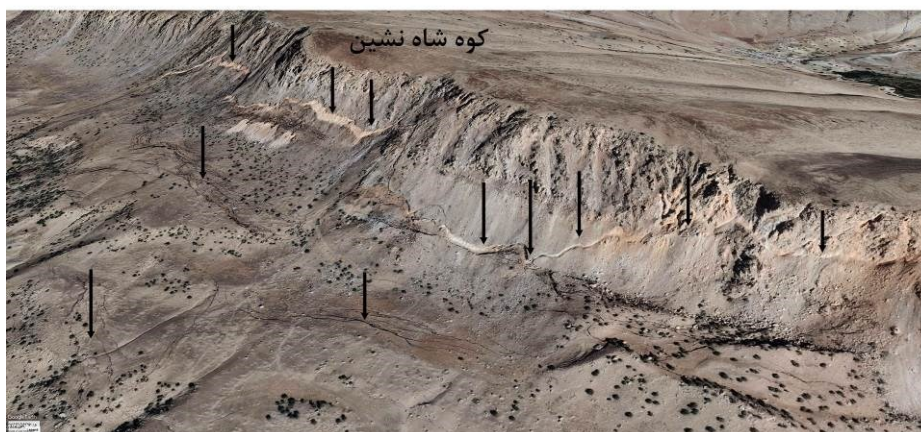
شکل (۳). زبانه های لغزشی در پای کوه شاه نشین ناشی از وقوع زمین لرزه ازگله.
