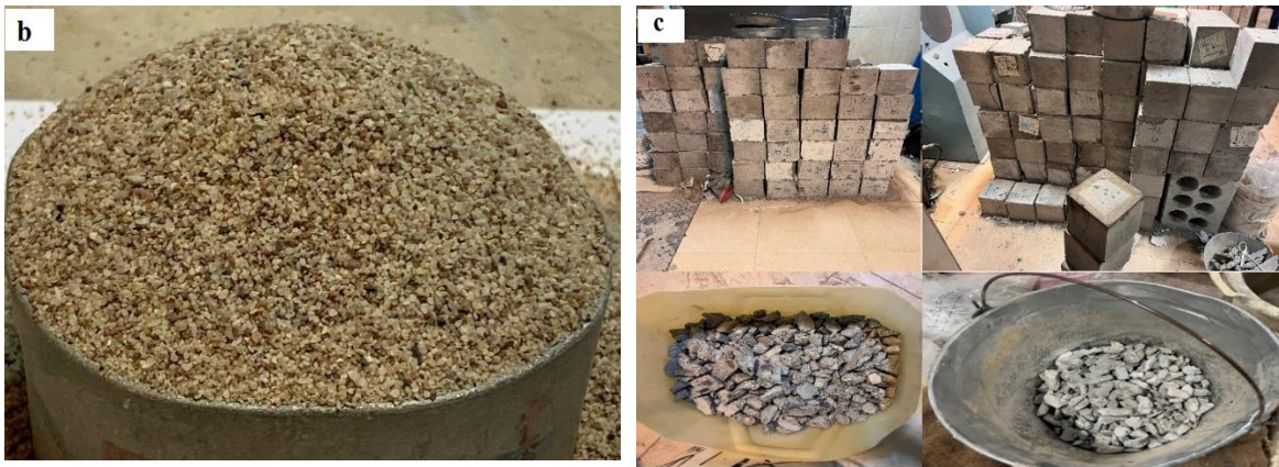
شکل ۱- (a) منحنی دانه‌بندی ماسه، (b) ماسه مورد استفاده، (c) ضایعات بتنی Fig. 1. (a) Sand's grain size distribution curve; (b) the used sand; (c) concrete waste material.
