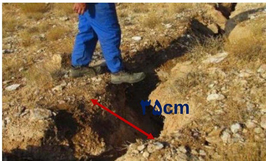
شکل ۱۶- نمونه درزه کشتی در سنگ‌های شیستی معدن سنجده
