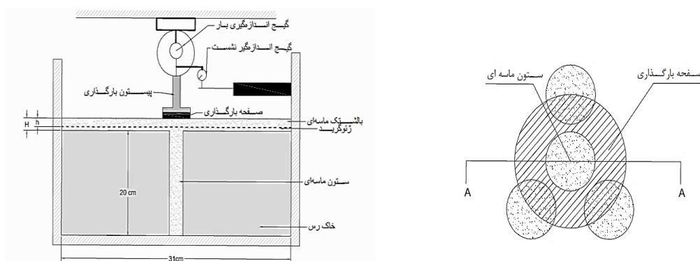
شکل ۴. شکل شماتیک جعبه و نمونه آزمایش.
