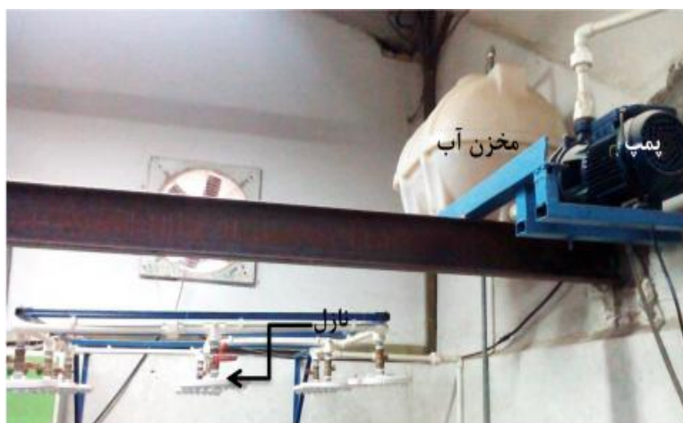
شکل ۴. بخش‌های مختلف دستگاه شبیه‌ساز باران استفاده شده
