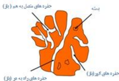
شکل ۲. نوع تخلخل‌ها بر اساس شکل و موقعیت [۲]
