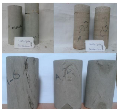
شکل ۶. تخریب نوع اول: تخریب نمونه‌های ماسه سنگی در امتداد سطوح ضعف از پیش موجود و لامینه‌ها (قطر نمونه‌ها ۵/۴ سانتی‌متر و طول آن‌ها ۱۴ سانتی‌متر است)
