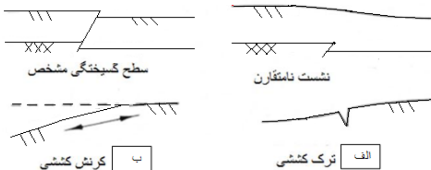
شکل ۱. حالت‌های گسیختگی مرتبط با گسلش سطحی
