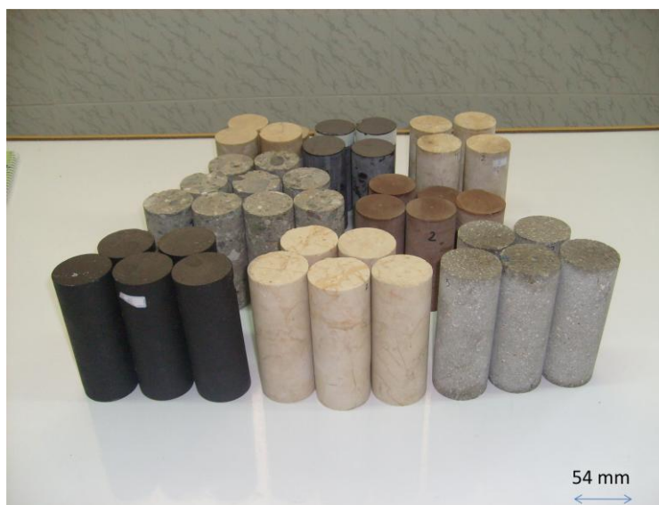
شکل ۶. مغزه‌های استوانه‌ای آماده‌سازی شده برای آزمایش اولتراسونیک
