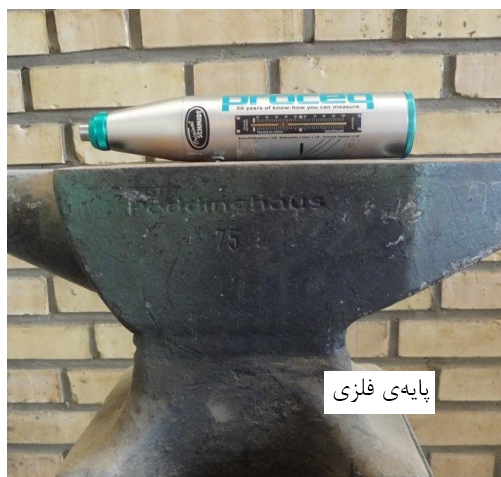
شکل ۲. چکش اشمیت به‌همراه پایه فلزی سنگین
