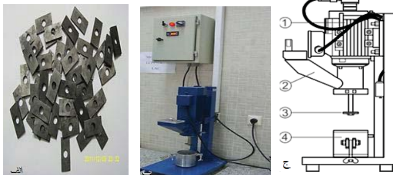
شکل ۵. مجموعه تجهیزات آزمایش LCPC با پروانه آن [۱۰]
