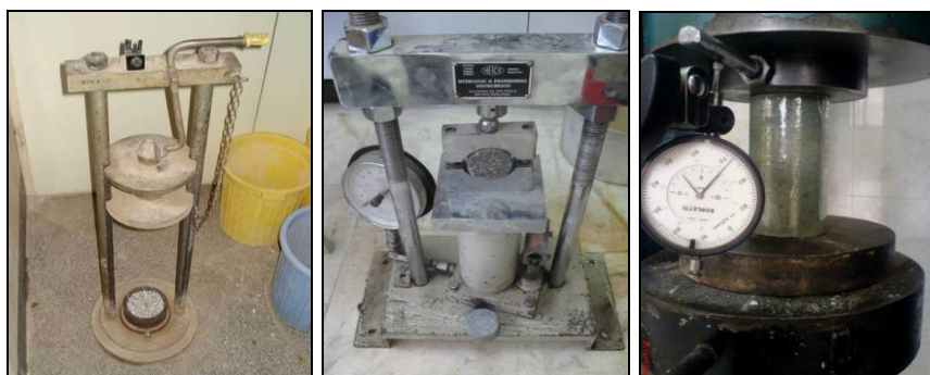
شکل ۱. انجام آزمایش مقاومت فشاری، برزلی و ارزش ضربه‌ای سنگدانه‌ها
