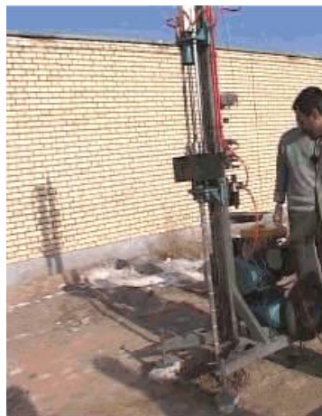
شکل (۳) کاوشگر دینامیکی موتوردار [۴]
