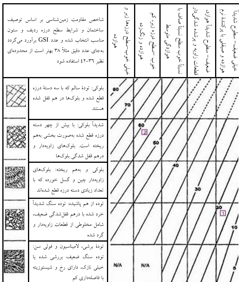
شکل ۸. طبقه‌بندی GSI توده‌های سنگی منطقه
