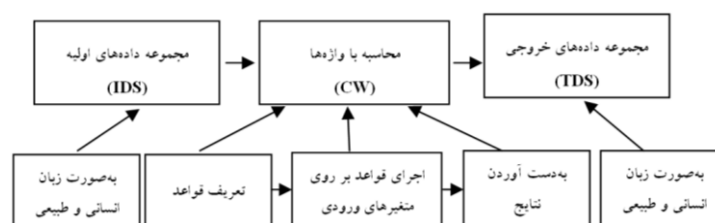
شکل ۶. الگوریتم نحوه عمل روش محاسبه با واژه‌ها [۲۱]
