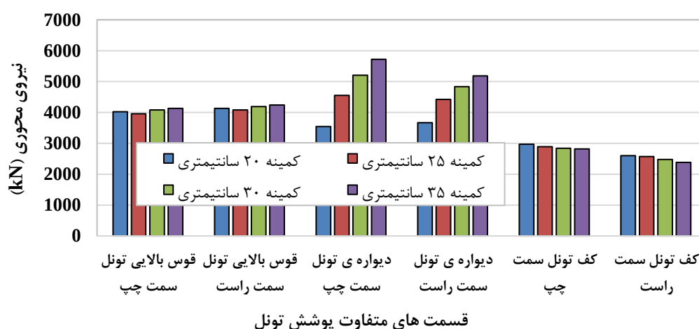
شکل ۱۳. کمینه مقادیر نیروی محوری در قسمت‌های متفاوت تونل با ضخامت متفاوت پوشش
