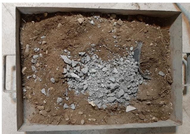
شکل ۲۲- اضافه کردن ۱۰٪ خرده بتن به پسماند ساختمانی
