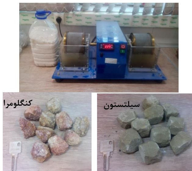
شکل ۶. دستگاه آزمایش دوام وارفنگی، نمک مورد استفاده و تعدادی از نمونه‌های تهیه شده
