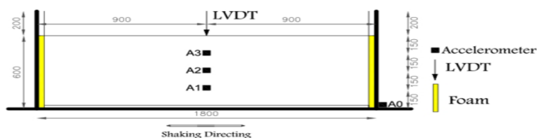
شکل ۲. شکل شماتیک نمونه‌های آزمایش همراه با ابزاربندی
