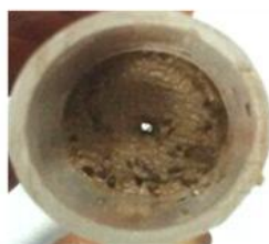
تغییر قطر سوراخ در پایان آزمایش در نمونه خاک منطقه بق قجه بالا با دانسیته حداکثر
