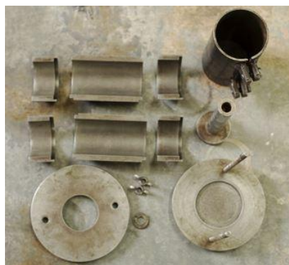
شکل ۱. قالب ویژه برای تهیه نمونه‌های آزمایشی تراکم استاتیکی
