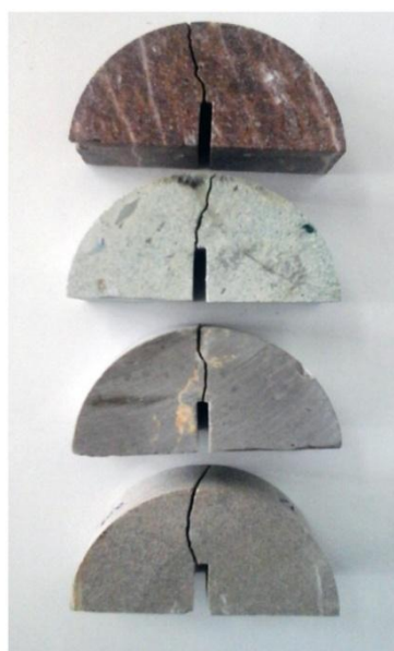
شکل ۳. نمونه‌ها بعد از آزمایش برای ۴ نوع سنگ (از بالا به پایین آندزیت، توف سبز، سنگ آهک و ماسه سنگ)
