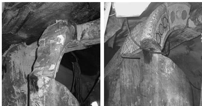
شکل ۴. یک باکت قبل از تعمیر (چپ) و بعد از تعمیر (راست) [۷]
