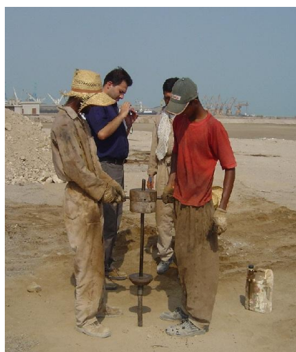
شکل ۲. ابزار کاوش‌گر دینامیکی دستی نوع متوسط [۴]
